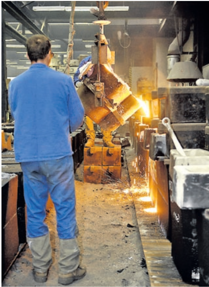
Das Giessen von Stahl ist Schwerarbeit und Hightech in einem. Bilder: Heinz Diener
