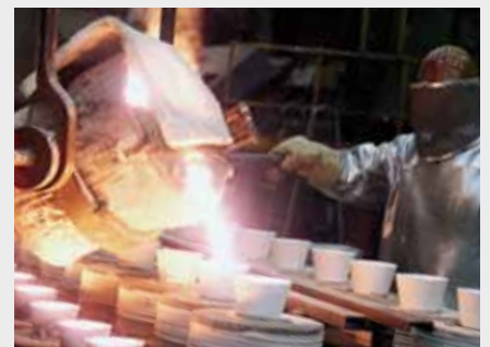
Keramischer Genauguss Exacast ®: gossen in heisse Formen.
