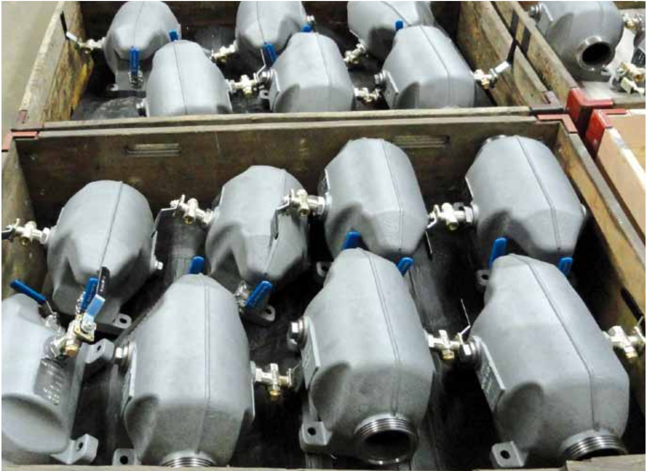
Bild 4: Bei diesem dünnwandigen, einteilig aus duktilem Gusseisen mit Kugelgraphit gegossenen Behälter begleitete Wolfensberger die gesamte Entwicklung von der Konstruktion und der Erstbemusterung bis zur Zulassung durch die Klassifikationsgesellschaften.
