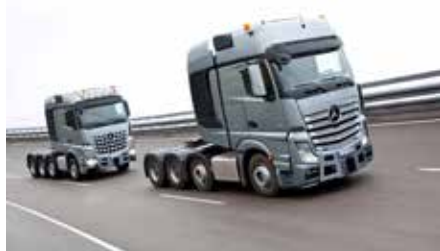
Ziehen bis zu 250 Tonnen über die Strasse: Die Schwerlastzugmaschinen Actros und Arocs SLT.
