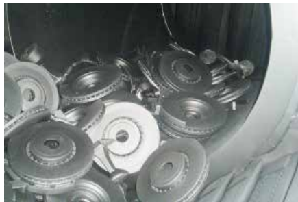
Gussteile in der Durchlauf-Trommel. Diese wird über eine verschleissfeste Kette angetrieben, für welche wir die Kettenglieder liefern.
