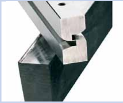
Gussrohling und einbaufertig bearbeitete Zuführschiene.
