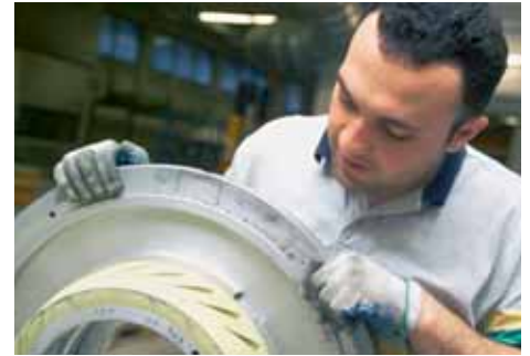
Formzusammenbau im keramischen Genauguss.
