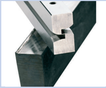
Gussrohling und einbaufertig bearbeitete Zuführschiene.
