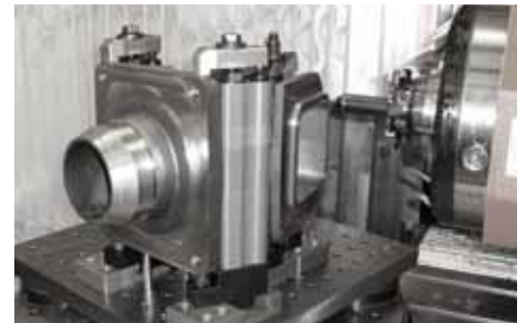
Kosteneinsparung: Eine auf die Bearbeitung hin optimierte Gussgestaltung.
