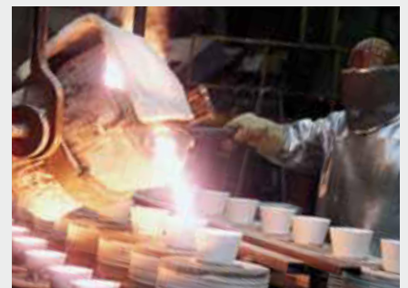
Keramischer Genauguss Exacast ®: gossen in heisse Formen.
